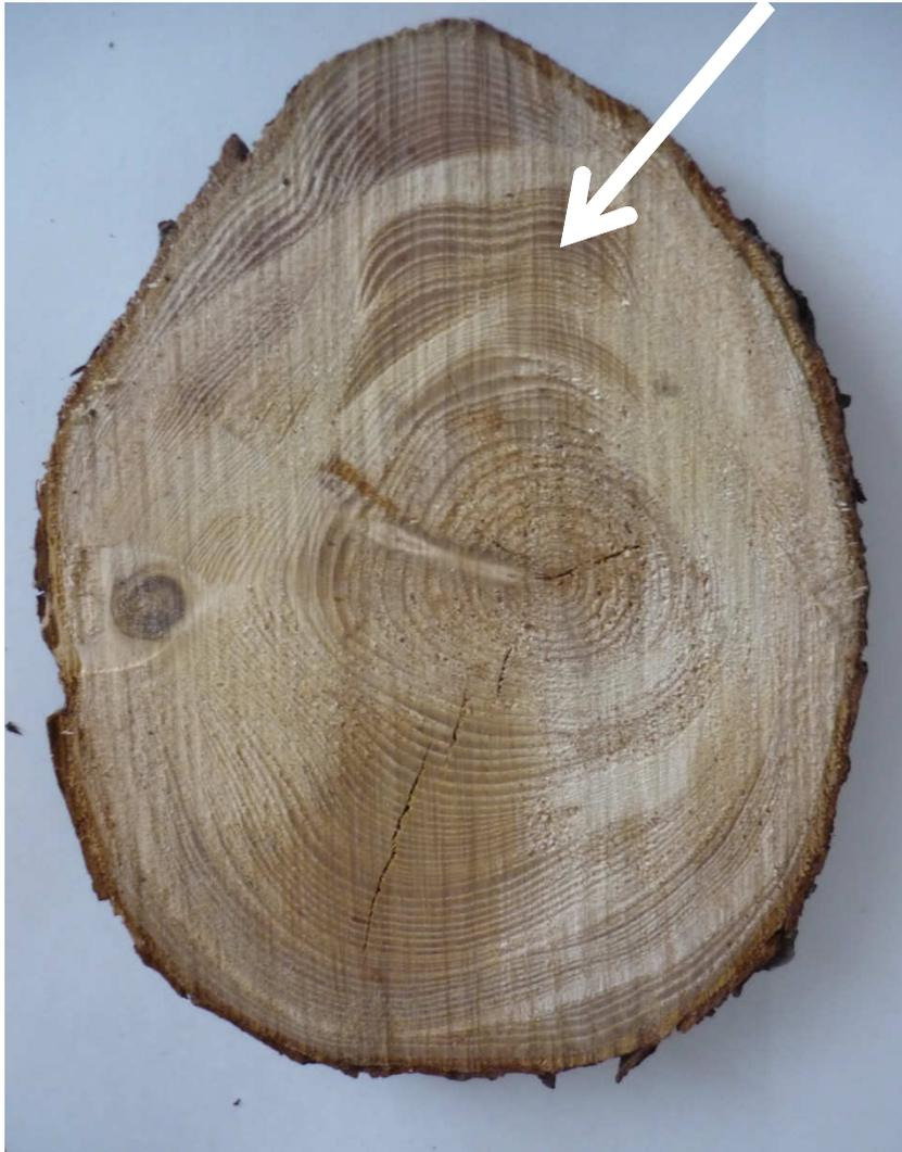
**Крень** – изменение строения древесины хвойных пород в сжатой зоне ствола и сучьев, проявляющееся в виде кажущегося резкого утолщения поздней зоны древесины годовых слоев.
