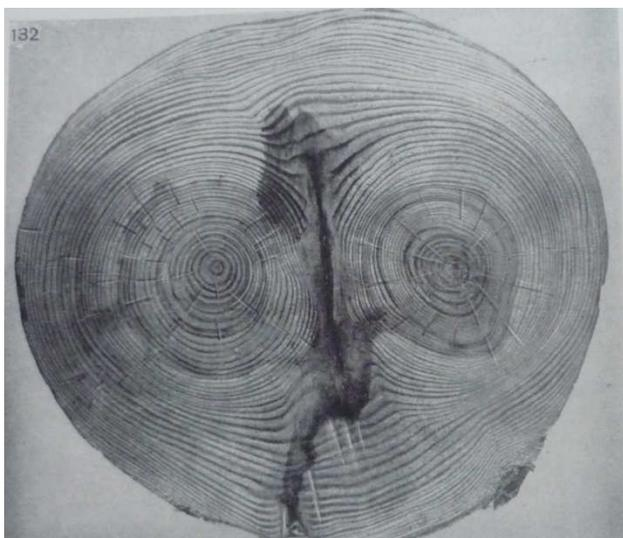
**Двойная сердцевина** – две и более сердцевины с самостоятельными системами годичных слоев, окруженных с периферии одной общей системой.
