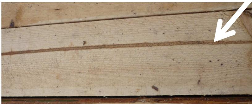
**Сердцевина** – узкая центральная часть ствола, состоящая из рыхлой ткани, бурого или более светлого цвета, чем окружающая древесина.
