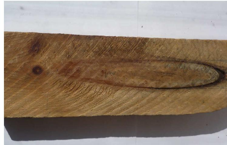
**Пасынок** – отставшая в росте или отмершая вторая вершина, проходящая через сортимент под острым углом к его продольной оси на значительном протяжении.
