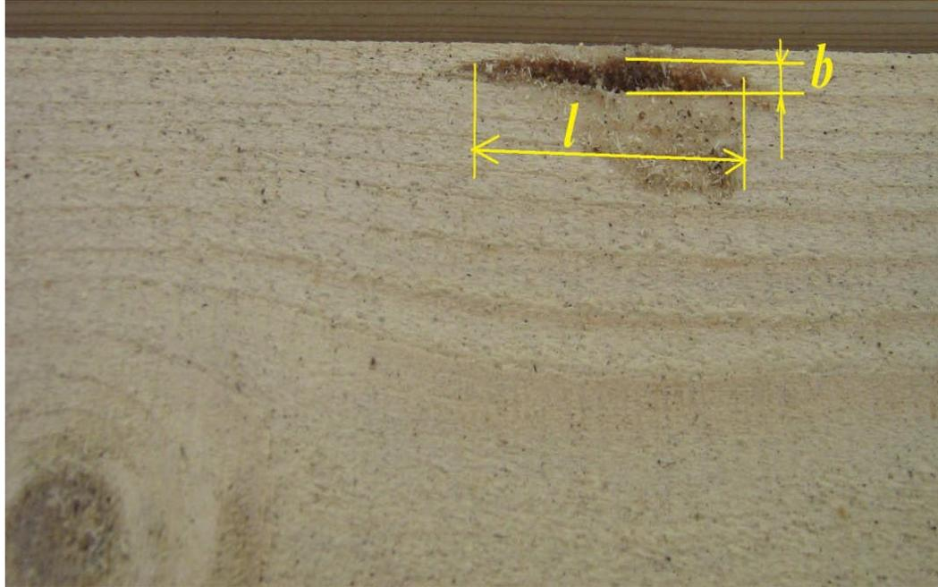
**Кармашек** – полость внутри или между годичными слоями, заполненная смолой или камедями. В пиломатериалах различают:
