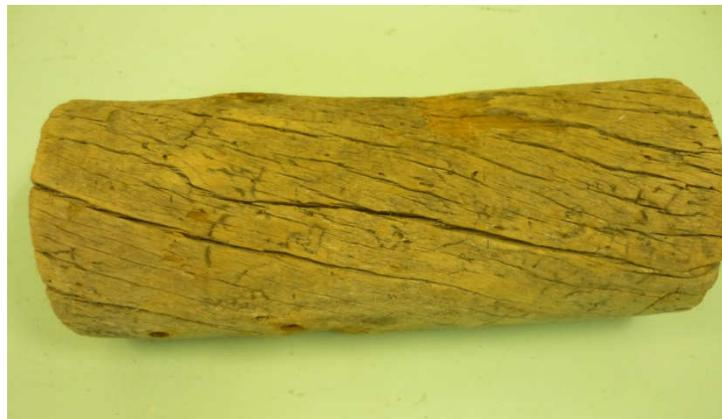
**Наклон волокон** – отклонение направления волокон от продольной оси лесоматериала. В п/п различают:
